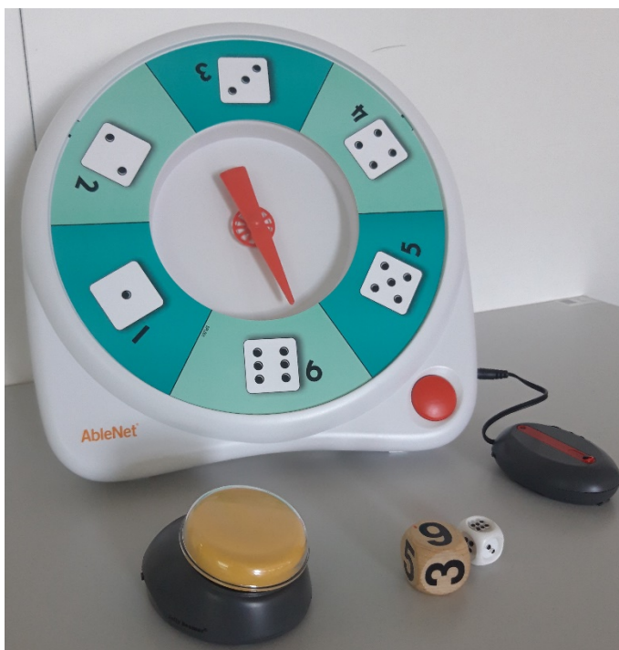
Abb. 6 „Jetzt würfel' ich!“ – Würfelmachine, kombiniert mit Taster mit Sprachausgabe (Foto: Marcel Feichtinger)
